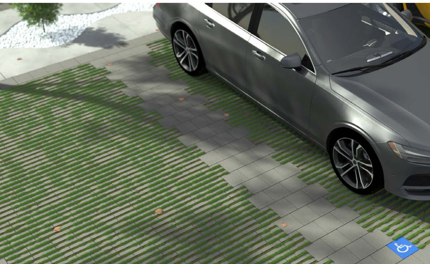
Toepassing parkeerplaats met uitstapstrook: Strike 22x7,3x8 cm kleur 'Arduna' in een lijnvormig verband, Flex Fusion 22x22x8 cm in kleur 'Arduna' in een halfsteensverband en de Flex symboolklinker 22x22x8 cm met rolstoel.
