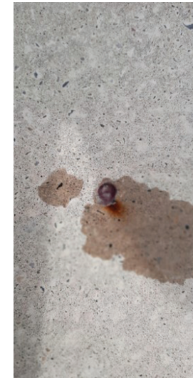
Lithofin Rost-Ex op ijzererts geeft een paarsbruisende reactie; opschuren met een spons en naspoulen met voldoende water
